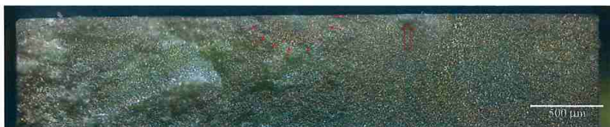
Figura 4.15 – Superfície de fratura do corpo-de-prova SCF que apresentou carga de ruptura de 277,7 N. A pré-trinca encontra-se no centro do corpo de prova, enquanto as linhas de propagação de fratura indicam a região assinalada pela seta vermelha como iniciador da fratura. MO 10x (montagem a partir de vários campos).
